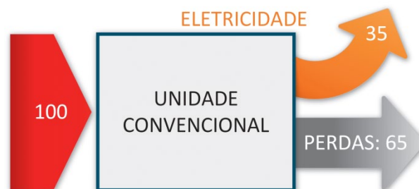
Figura 23 - Rendimento de uma unidade convencional de geração de energia elétrica (MEESI, 2010).
