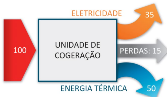
Figura 24 - Rendimento de uma unidade de cogeração de geração de energia elétrica (MEESI, 2010).
