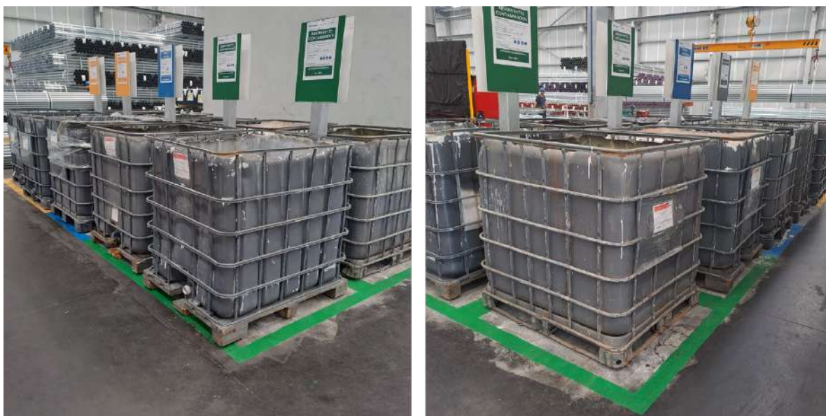
Figura 38 - Novas marcações no pavimento a delinear as zonas de colocação dos recipientes de resíduos.
