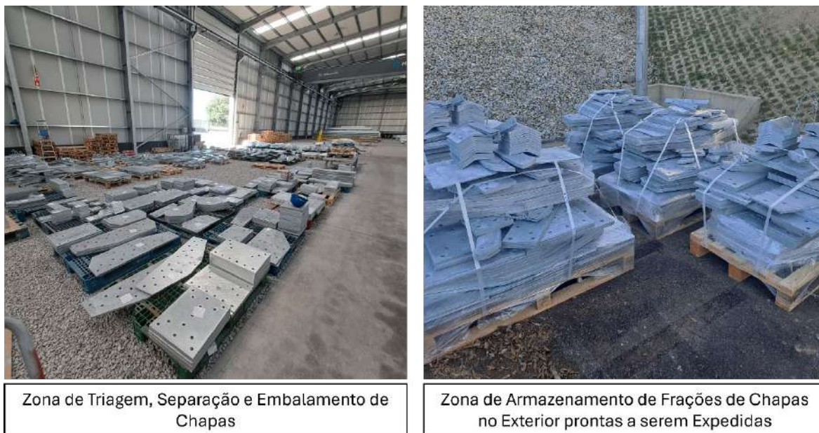
Figura 51 - Operações de triagem, embalagem e armazenamento das chapas no pavilhão da MTG6 reconvertido (esquerda) e zona de armazenamento das frações de chapa no exterior do pavilhão (direita).
