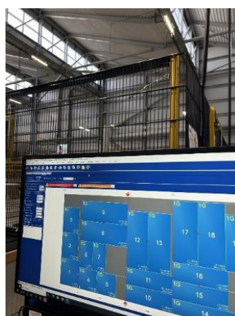
Figura 11 - Planos de corte enviados para as mesas de corte.
