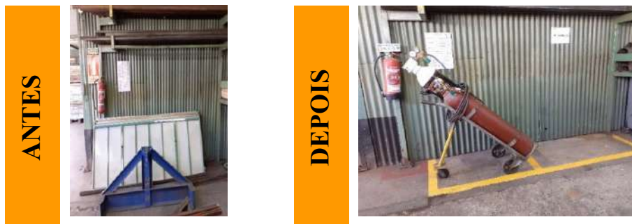
Figura 100. Comparação da situação antes e da situação depois da implementação dos 5S, relativa ao exterior desobstruído e local para acetileno, oxigénio e stacker nos setores T5c e T6c.
