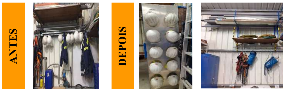
Figura 29. Comparação da situação antes e da situação depois da implementação dos 5S, relativa aos equipamentos de proteção individual no setor T1c.
