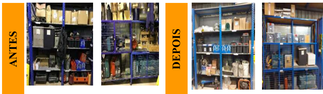
Figura 26. Comparação da situação antes e da situação depois da implementação dos 5S nos armários de materiais de construção civil e pequenos equipamentos no setor T1c.
