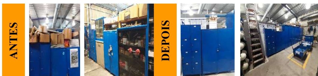
Figura 28. Comparação da situação antes e da situação depois da implementação dos 5S, relativa aos armários de pichelaria, carpintaria e serviços gerais no setor T1c.
