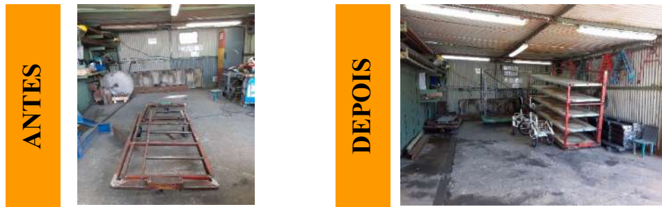
Figura 43. Comparação da situação antes e da situação depois da implementação dos 5S, relativa ao local para armazenamento de carros de pneus e outros materiais auxiliares nos setores T5c e T6c.
