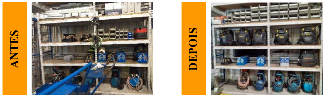
Figura 32. Comparação da situação antes e da situação depois da implementação dos 5S, relativa ao armazenamento dos materiais nos armários no setor T2c.
