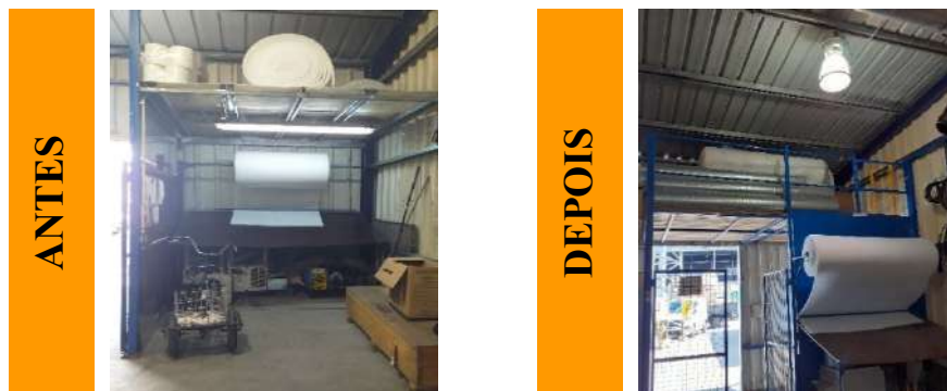
Figura 39. Comparação da situação antes e da situação depois da implementação dos 5S, relativa ao local dos rolos de filtros nos setores T3c e T4c.
