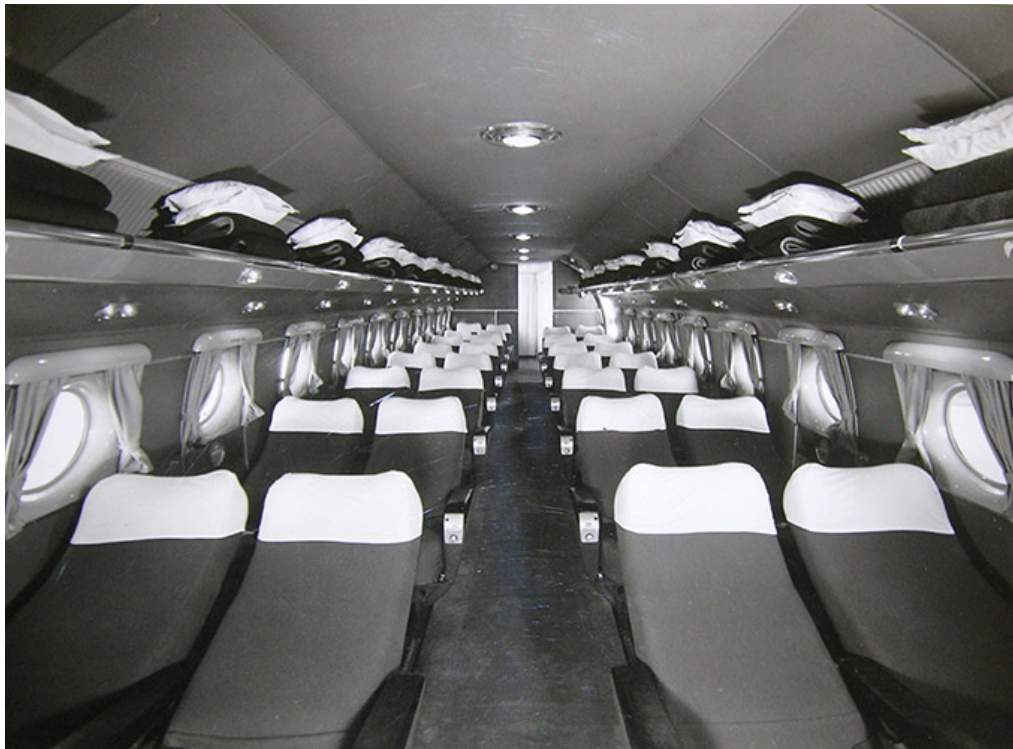
Fig. 5 – Interior da cabina de passageiros de um Skymaster da TAP após a beneficiação de 1954; note-se a capacidade de reclinção dos novos assentos.
