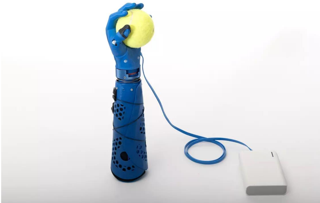
Figura 3 – Prótese de mão de custo reduzido, impressa em 3D para crianças, da Universidade de Engenharia da Suíça
