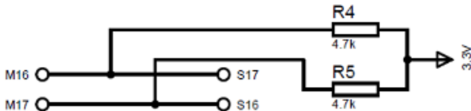
Figura 72 - Pull-up no barramento serial UART2 do Master e Slave MCU
