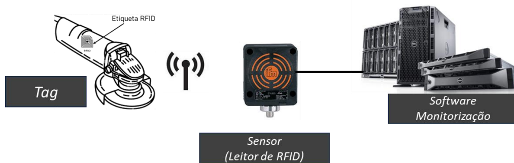
Figura 44 – Elementos de funcionamento da tecnologia RFID para rastreabilidade de máquinas.
