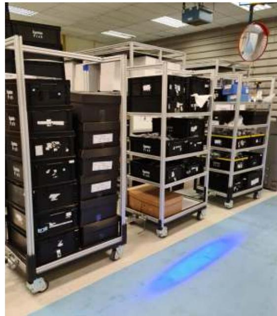
Figura 41 - Comboio 35UP-High antes da aplicação do 5S: excesso de materiais nos trailers frontais
