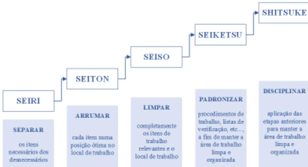
Figura 4 - 5S e respetivas definições (adaptado de Kato e Smalley, 2011)
