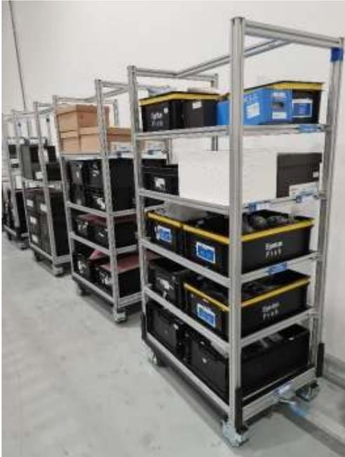
Figura 44 - Comboio 35UP-High após aplicação do 5S: posições fixas
