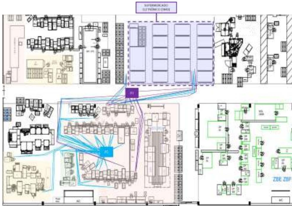
Figura 18 - Diagrama de movimentação: abastecimento 35UP-High turno da tarde
