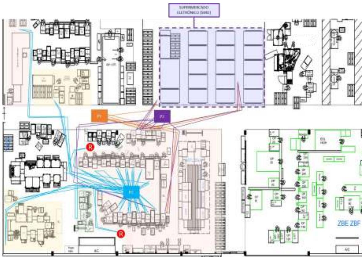
Figura 34 - Diagrama de movimentação após melhorias: abastecimento 35UP-High turno da manhã
