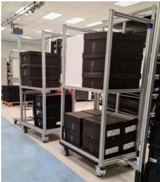
Figura 40 - Comboio 35UP-High antes da aplicação do 5S: excesso de materiais nos trailers traseiros
