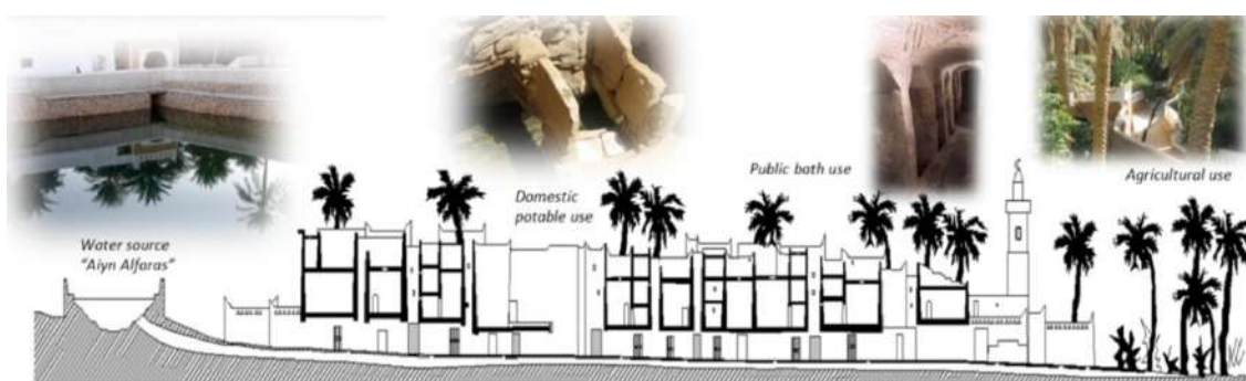
Ilustração 9 – Sistema de alimentação e distribuição de água através da gravidade. (Alabid et. al. , 2015, p.9).
