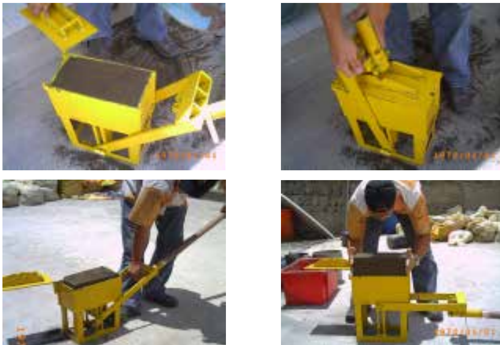
Ilustração 33 – Execução dos BTC em prensa manual CINVA-Ram. (Coelho, Torgal e Jalali, 2009, p. 65).
