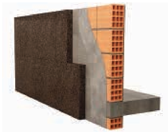
Ilustração 71 – Parede de tijolo com isolamento térmico à vista em aglomerado de cortiça expandida. (Amorim Cork Insulation, 2020).
