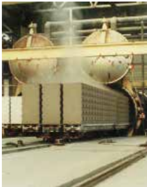
Ilustração 89 – Cura de betão celular em autoclave, Guerreiro, 2002. (Coelho, Torgal e Jalali, 2009, p. 49).
