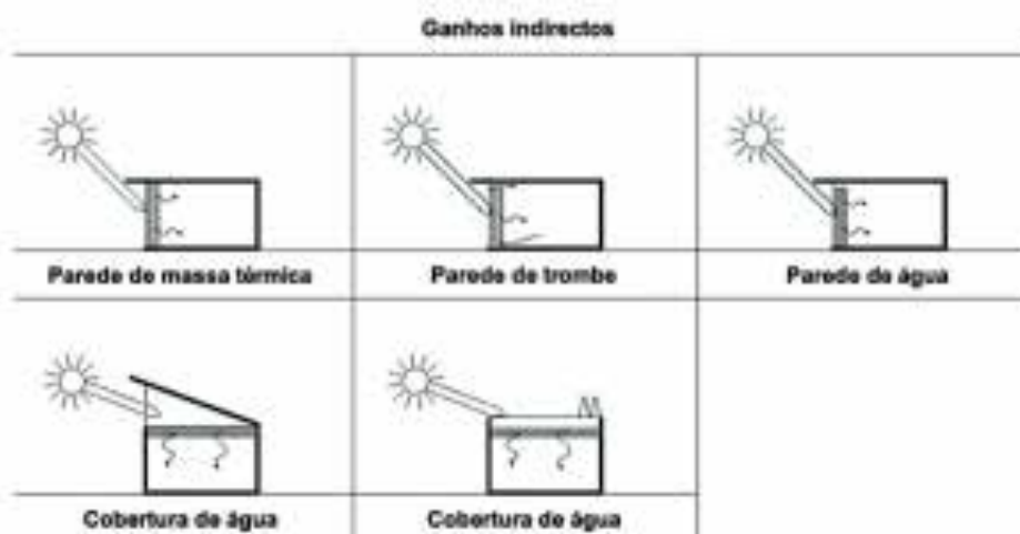
Ilustração 153 – Tipologias de aquecimento solar passivo com ganhos indirectos (Pinto e Dias, 2015, p. 85).
