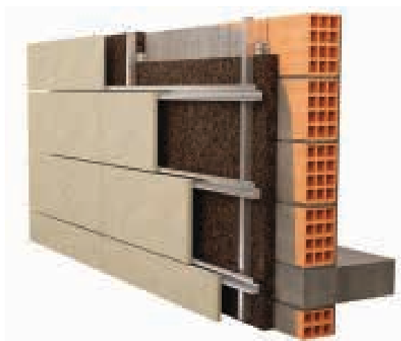
Ilustração 120 – Paredes ventiladas com sistema de fixação linear (indirecto) oculto e isolamento aglomerado de cortiça expandida pelo exterior. (Amorim Cork Insulation, 2020).
