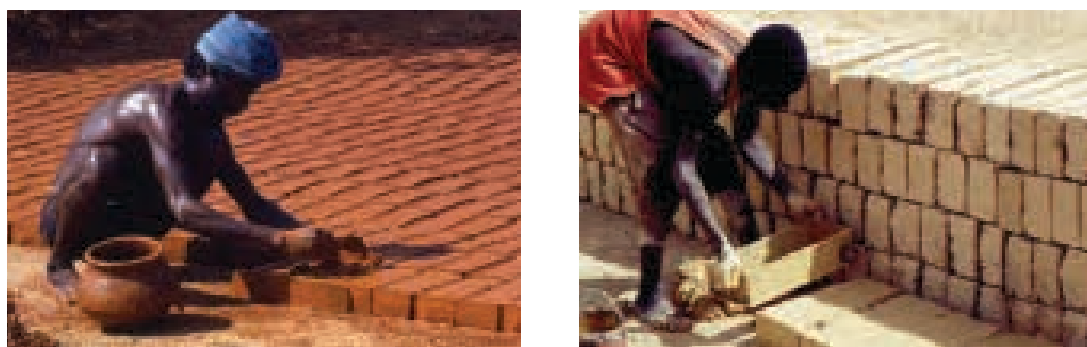
Ilustração 23 – Produção manual de adobe em vários pontos do mundo. (Auroville Earth Institute, 2020).
