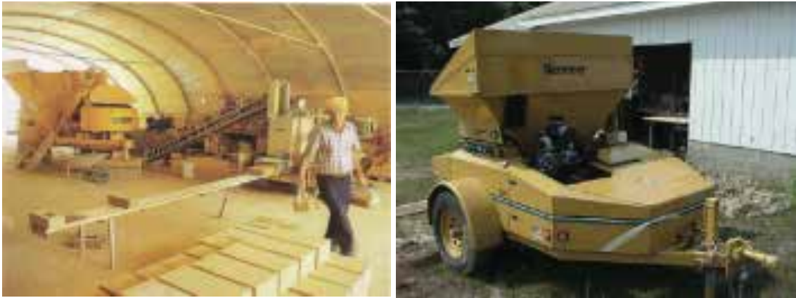
Ilustração 34 – Prensas hidráulicas de BTC, à direita, fixa (Quintino, 2005) e à esquerda, móvel. (Torgal, Eires e Jalali, 2009, p. 53).
