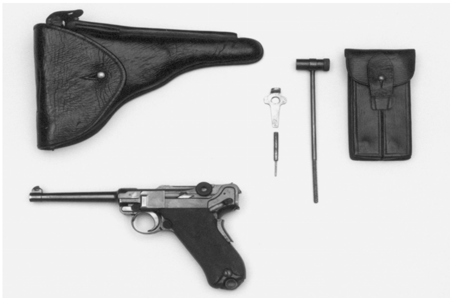
Fig. 18 - Pistola 7, 65 mm m/908 Parabellum, destinada aos oficiais do Exército, com o respectivo coldre e acessórios.
