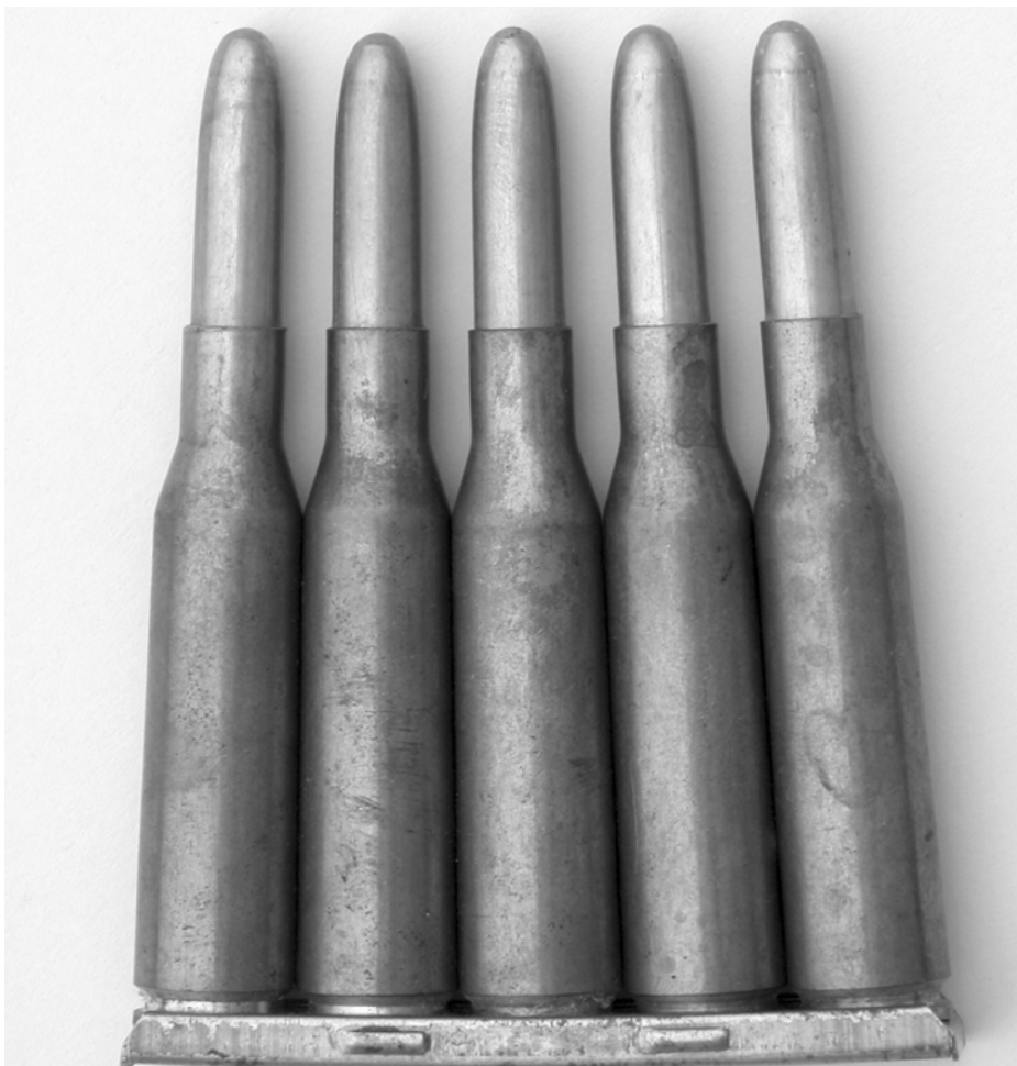
Fig. 10 - Munições 6,5 x 58 para a Mauser-Vergueiro na respectiva lâmina carregadora.
