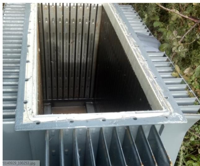
Figura 13: Cuba de um transformador 630 kVA [EDP].
