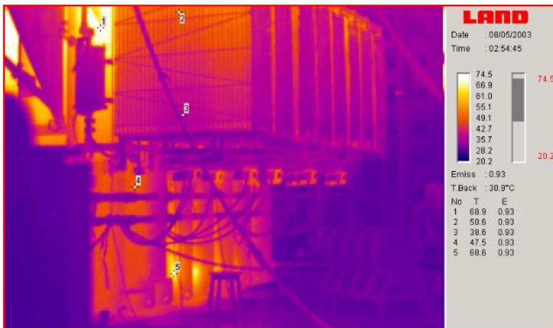
Figura 38: Medição da temperatura utilizando câmaras infravermelhas [54].
