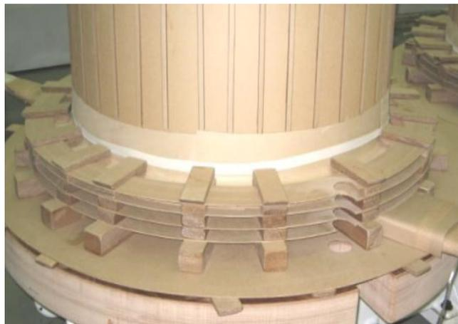
**Figura 20:** Calços e isolamento [31].
