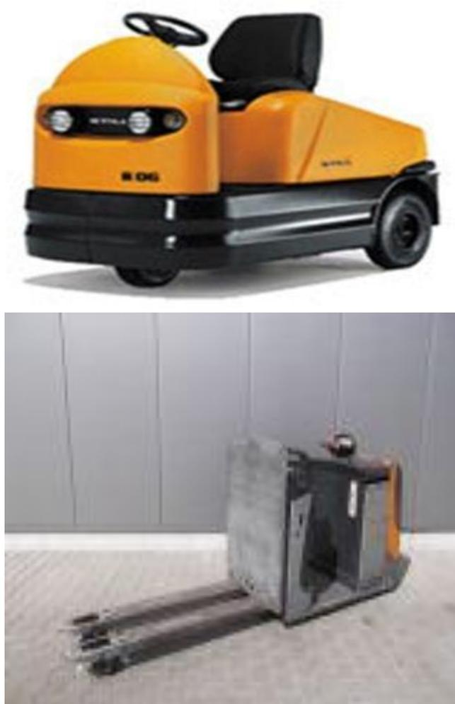
**Ilustração 17 – Pimespo e Empilhador de Pisos**
