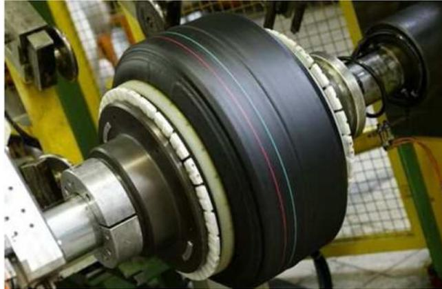
**Ilustração 11 – Construção de pneus em verde**
