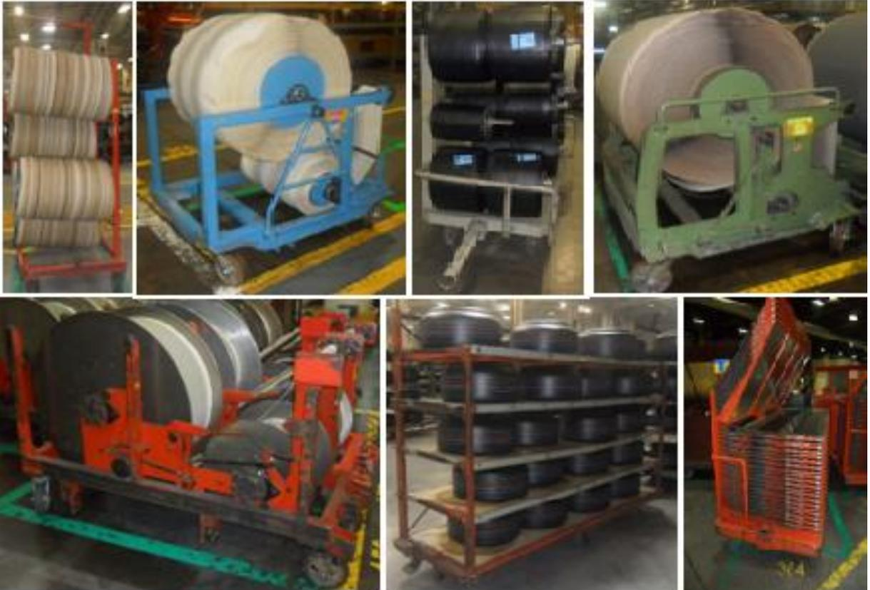
**Ilustração 16 – Suportes de armazenamento dos materiais**
