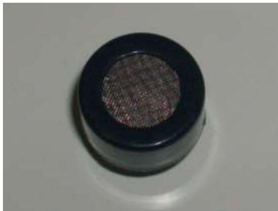
Figura 40: Sensor de nível de álcool MQ-3 [22].
