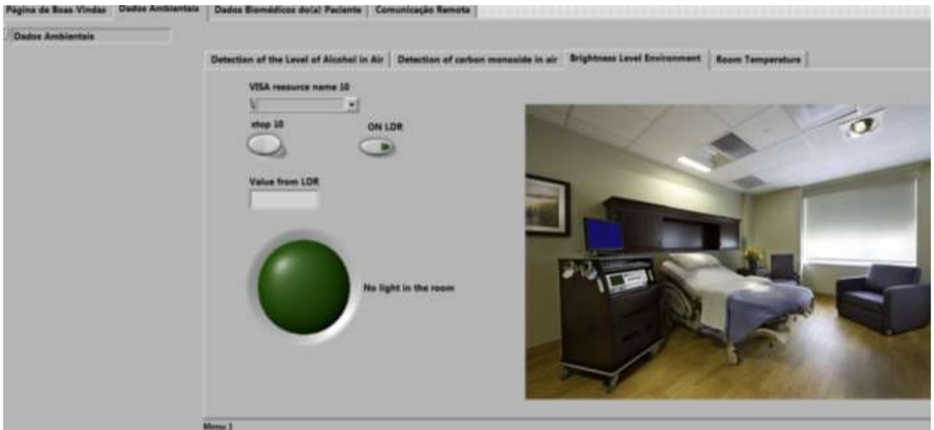
Figura 96: Interface em Labview do MCT para o nível de luminosidade no quarto
